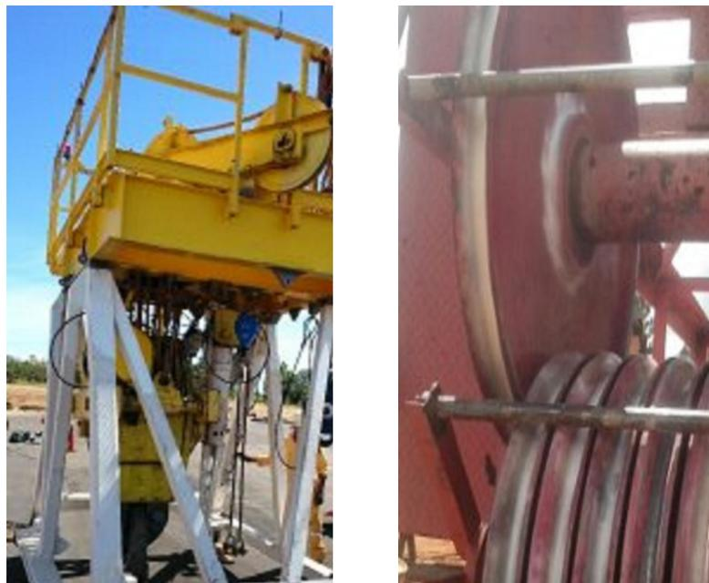
Foto 11.- Trabajo de Inspección Bloque Corona de EDV 42.
