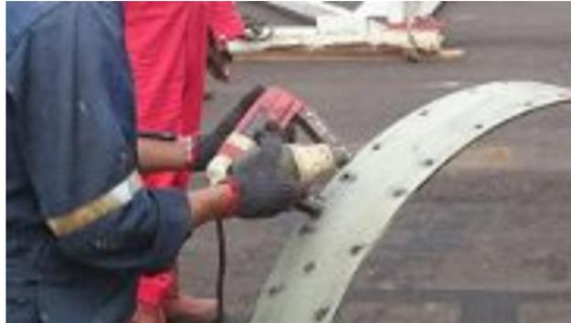
Foto 9. Trabajo de Inspección END Bandas de Malacate.
