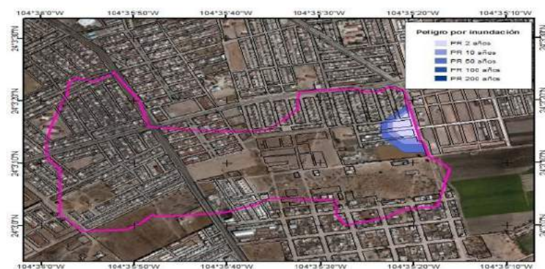
Figura 12. Peligro por inundación según diferentes periodos de retorno en la microcuenca San Luis. Fuente: Atlas de Riesgo del Municipio de Durango
